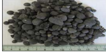
Şekil 3. %20 RDF + %80 LPG kullanılarak üretilen klinker numunesi
